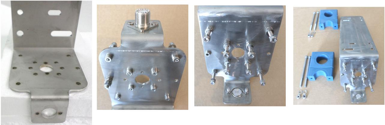
Installare le 8 viti 4x25MA nei fori a formare una X e il bullone 4x16MA nel foro laterale come da immagini.
